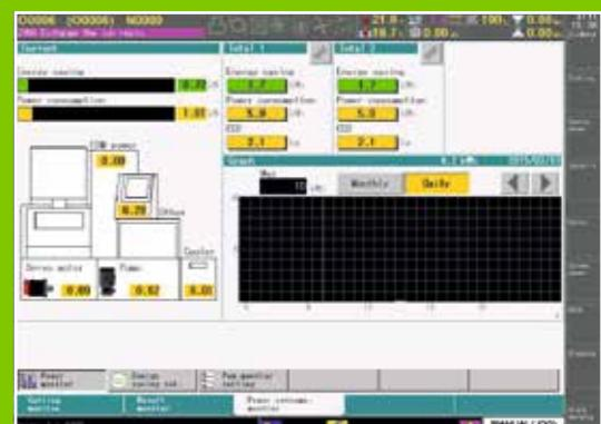
ROBOCUT позволяет с высокой точностью отслеживать количество энергии, потребляемое во время обработки и простоев. Кроме того, при необходимости возможна тонкая настройка режима энергосбережения: отключение промывки и насоса фильтрации, настройка отключения экрана, режим сна, автозапуск и автоворыноключение станка в заданное время.
